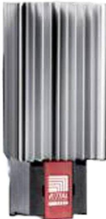
In der Schaltschrank des Führanlages integriertes Heizelement. Verhindert Kondensation und Einfrieren der elektrischen Komponenten. Bestehend aus einem Heizelement mit Temperatursensor, das bei einer Temperatur unter 5 Grad Celsius einschaltet. Das ganze ist im Schaltschrank eingebaut.
