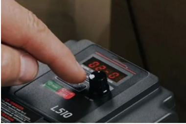
Programmieren des Frequenzumrichter
