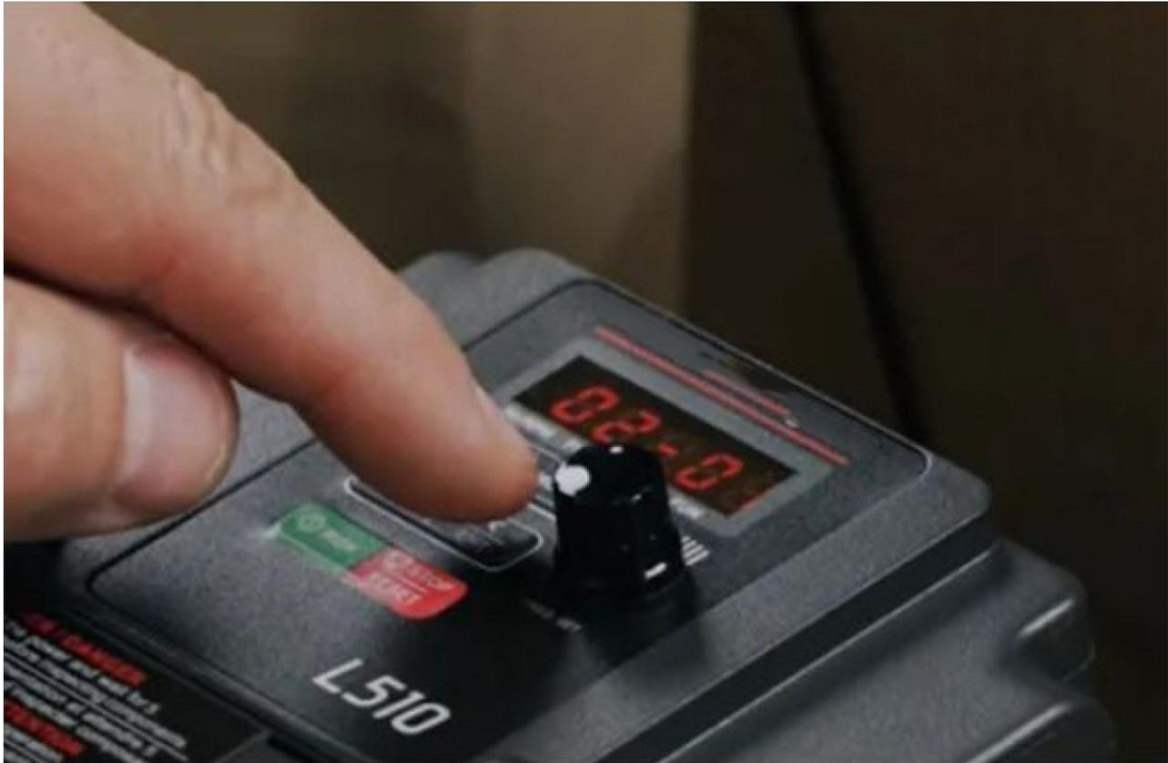
Der Frequenzumrichter wird entsprechend den korrekten Spezifikationen des Motors oder der Maschine programmiert
